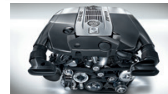
Dvanáctiválcový zážehový motor AMG V12
